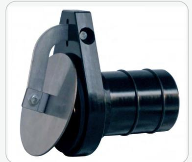
**INSTALLATION:** Zwei Gummiringe werden am Rohrende für die Abdichtung zwischen dem bestehenden Rohr und dem neuen Klappenventil montiert. Zur Installation in einem bestehenden Rohrsystem (Innendurchmesser des bestehenden Rohrs anzugeben).
