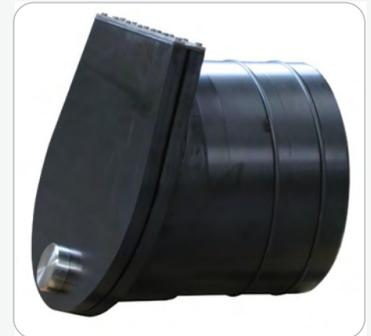
**INSTALLATION:** Zwei Gummiringe werden am Rohrende für die Abdichtung zwischen dem bestehenden Rohr und dem neuen Klappenventil montiert. Zur Installation in einem bestehenden Rohrsystem (Innendurchmesser des bestehenden Rohrs anzugeben).
